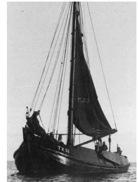
De blazer TX 33. Denk het berghout weg en je ziet de naar binnen vallende boorden van de zoveel kleinere vissersjoll uit Stavoren.
